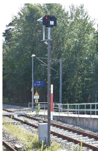
Hohes Lichtsperrsignal mit nur einem Rotlicht
